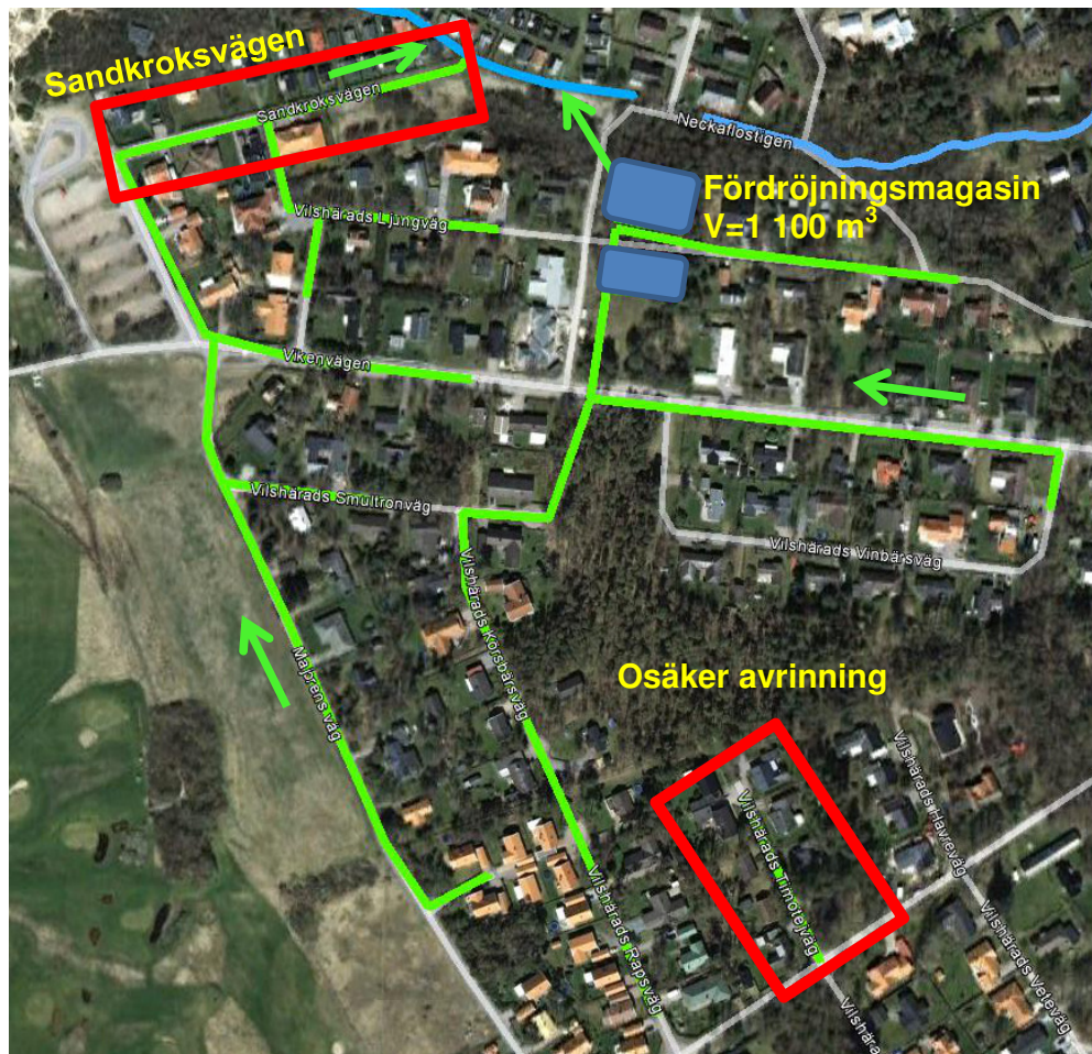
Bild 40. Dagvattensystem i västra Vilshärad.
