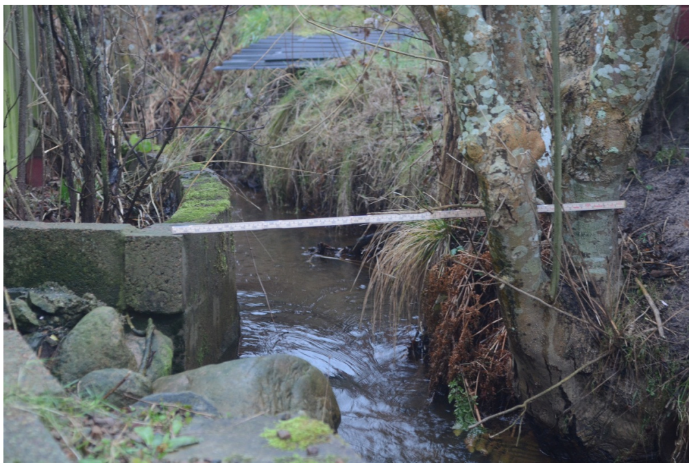
Bild 23. Trång sektion genom bäckens stugförening. Tumstocken på bilden är utfäld till 1 m.
